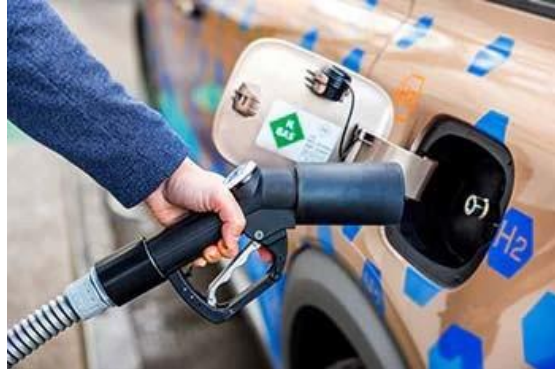
Het vulmondstuk voor gas lijkt sterk op dat voor andere gassen voor voertuigen (Plaatje 12).
