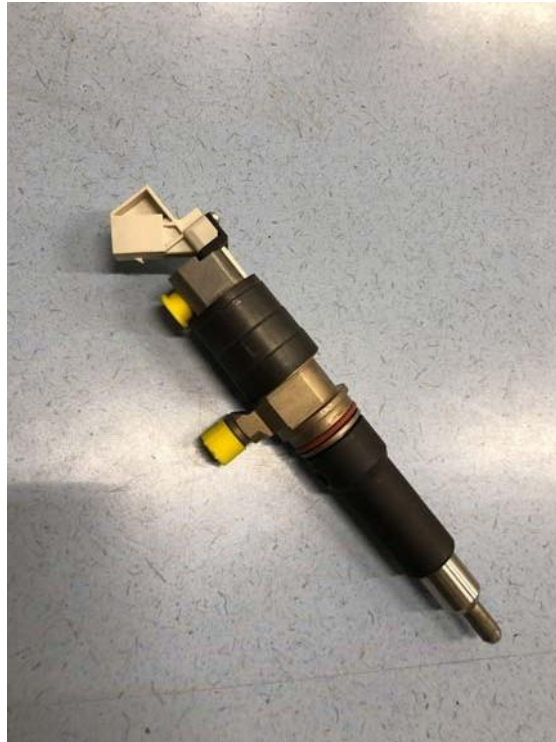
Hier wordt een voorbeeld beschreven, deze dubbele injector is ontwikkeld door het bedrijf Westport. (Afbeelding 23)
