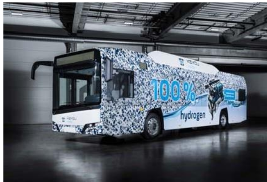
Een bus aangedreven door waterstof met een conventionele motor, Keyou is het bedrijf erachter (Plaatje 8)
