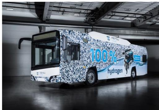
Autobus con motor convencional propulsado por hidrógeno, Keyou es la empresa de fabricación (Imagen 8)
