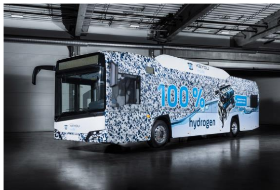
Ein mit Wasserstoff betriebener Bus mit konventionellem Motor, Keyou ist das Unternehmen dahinter (Bild 8)
