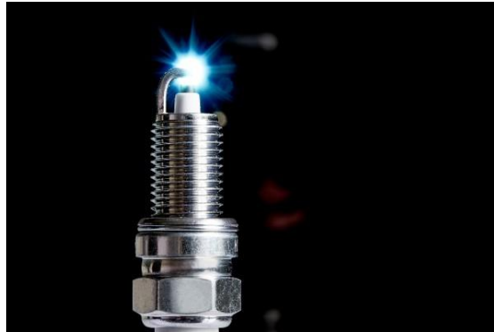
Eine konventionelle Zündkerze wird auch in einigen Arten von Wasserstoffmotoren verwendet (Bild 20).
